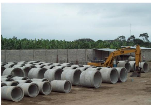
**FIGURA 3.4.- TUBERÍAS DE HORMIGÓN ARMADO**
