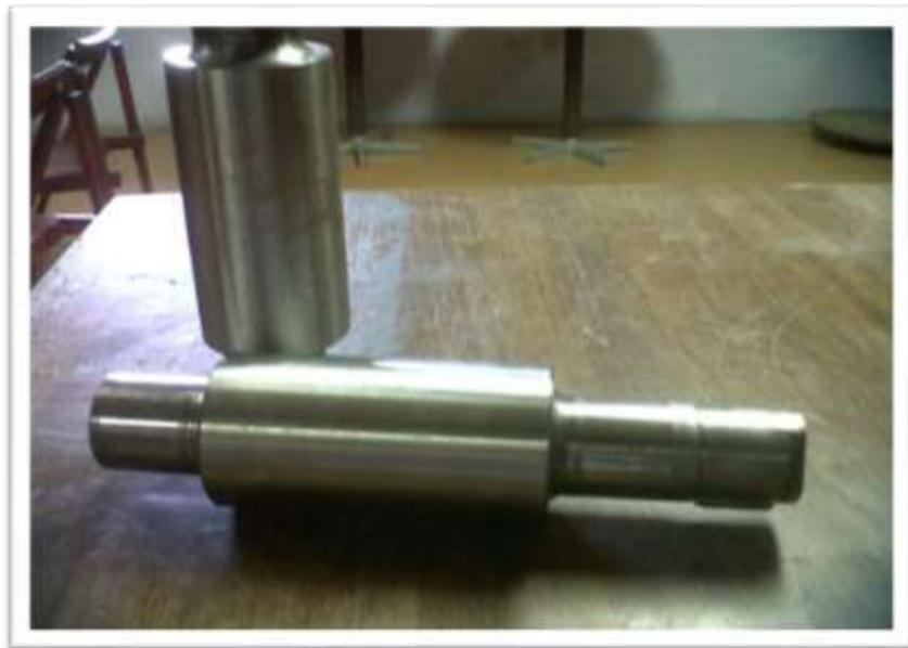
**FIGURA 1.2. RODILLOS DE LAMINACIÓN**
