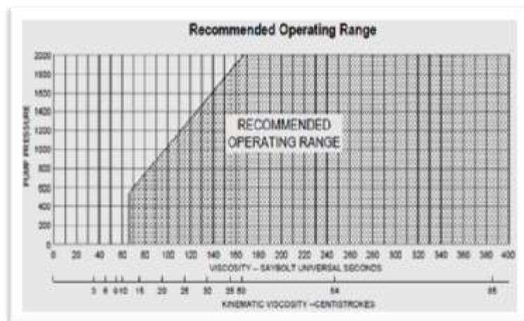
**FIGURA 2.17. RANGO DE OPERACIÓN DE LAS BOMBAS**
