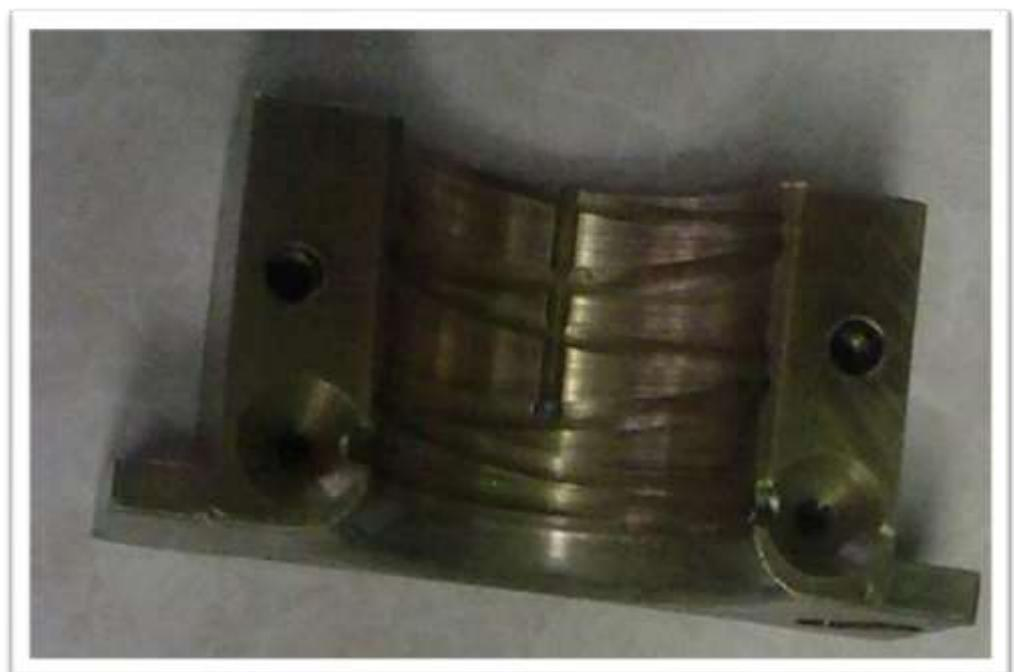
**FIGURA 1.3. COJINETE DE DESLIZAMIENTO CON ROSCAS DEFORMADAS.**
