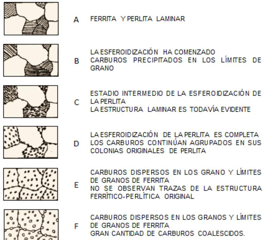
**FIGURA 1.7. DEGRADACION MICROESTRUCTURAL INICIAL DEL ACERO BAJO CREEP. [13]**
