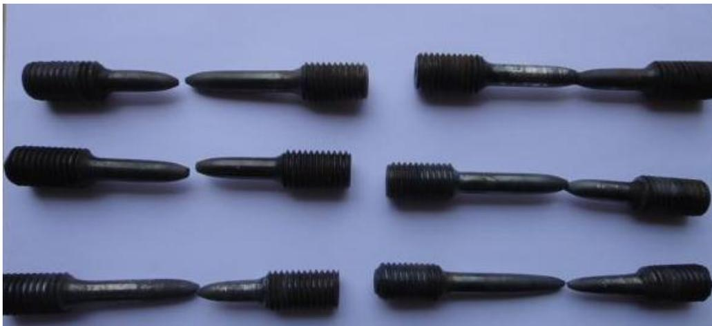
**FIGURA 4.2. GRUPO DE PROBETAS FRACTURADAS.**
