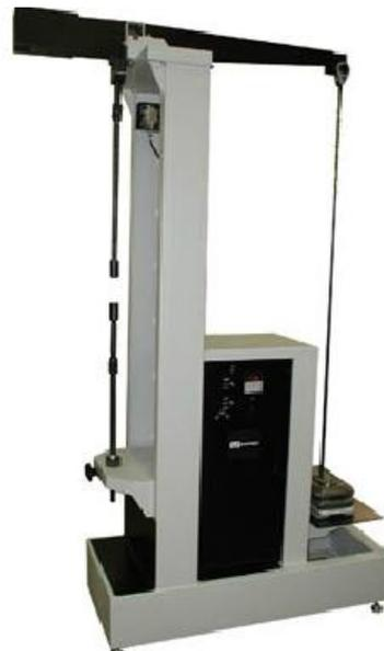
**FIGURA 1.25. DISPOSITIVO DE ENSAYO CREEP INSTRON.**
