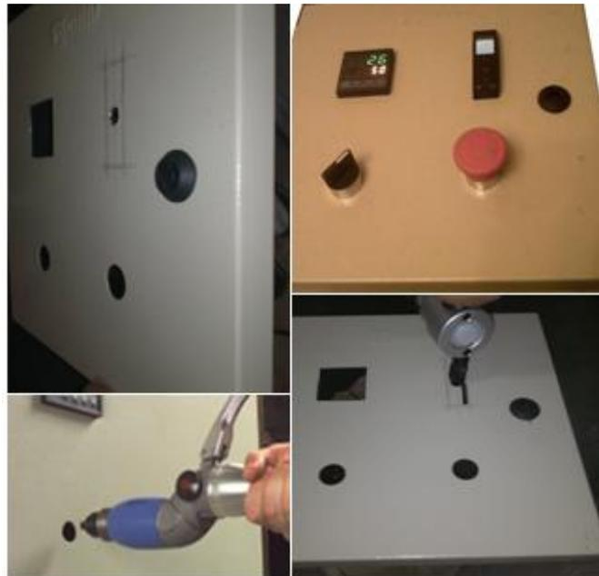
**FIGURA 2.23. FABRICACION DEL PANEL FRONTAL**
