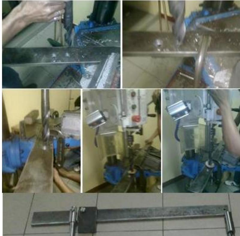
**FIGURA 2.17. CONSTRUCCIÓN DEL BRAZO PALANCA**
