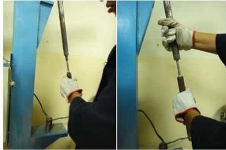
**FIGURA 3.4. COLOCACION DE LA PROBETA.**
