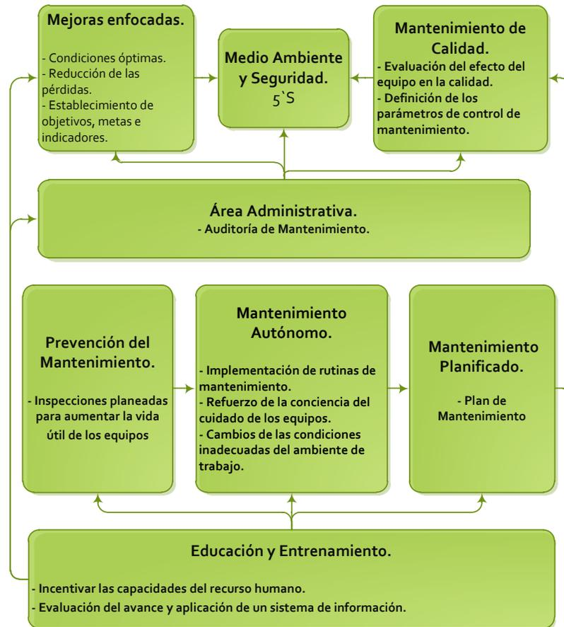
**Figura 5.1 Diagrama de Relación entre los 8 pilares del T.P.M.**
