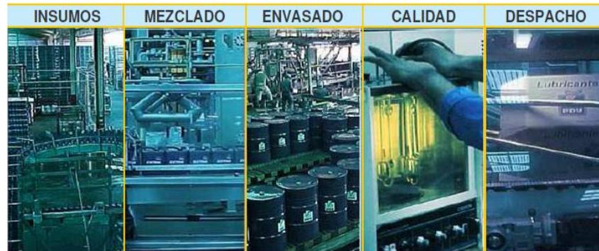
**Figura 3.4 Procesos para la elaboración de los lubricantes**
