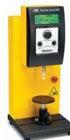
Figura 2.12. Texturómetro de Brookfield
