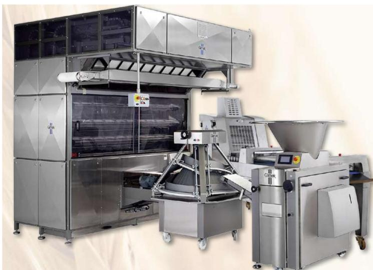
Figura 1.13- Línea de Producción de Pan Molde
