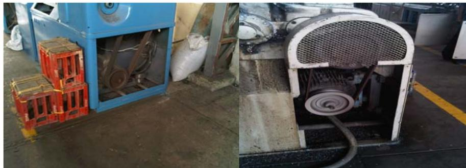
**FIGURA 4.11 FALTA DE GUARDAS EN LAS MÁQUINAS**
