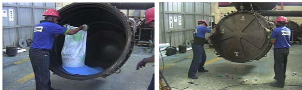
**FIGURA 4.7 CARGAR EL MATERIAL Y ABRIR/CERRAR EL MOLDE**
