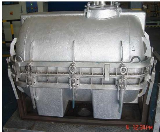
**FIGURA 3.4 MOLDE DE ROTOMOLDEO**
