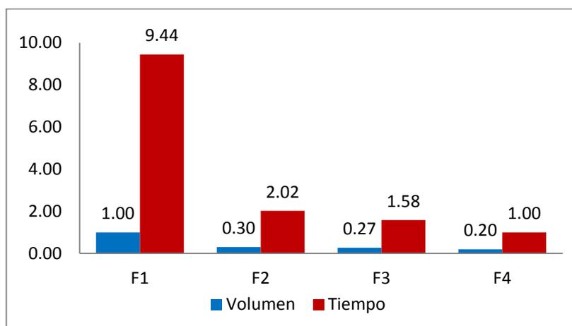
**GRÁFICA 3.14** VOLUMEN REMOVIDO PARA LAS DIFERENTES VELOCIDADES DE CORTE DE LA HERRAMIENTA TNMG160408-PM GC4225.
