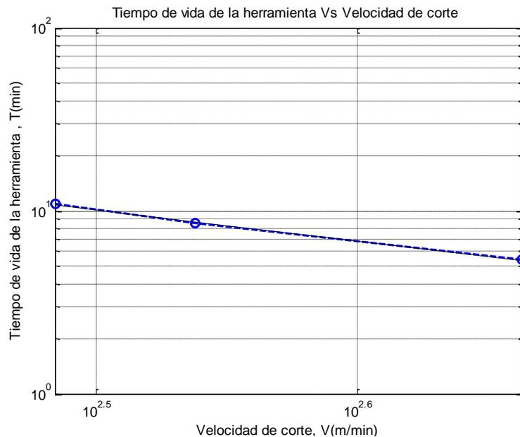
**GRÁFICA 3.6 CURVA V-T PARA  $V_{B_0}=0.3\text{mm}$  ( $V_c=305\text{-}460\text{ m/min}$ )**
