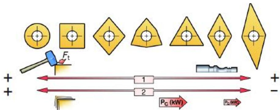
**FIGURA 1.14** COMPARACIÓN ENTRE PLAQUITAS DE DIVERSAS GEOMETRÍAS (1).
