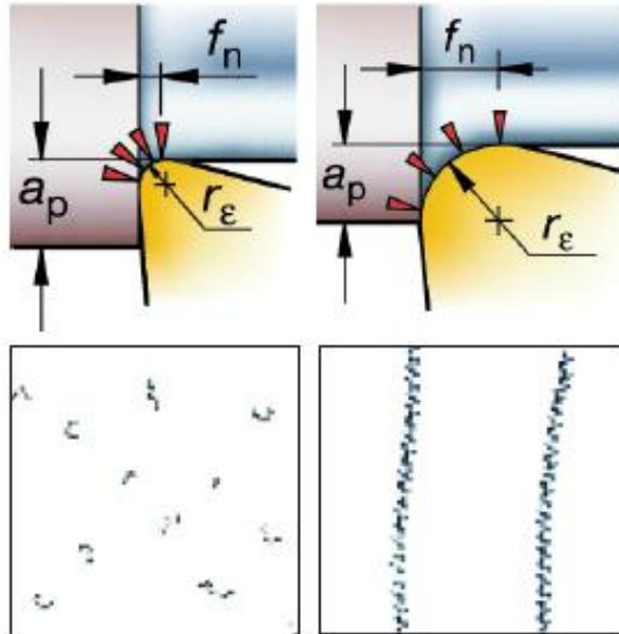
**FIGURA 1.16** TIPO DE VIRUTA OBTENIDO PARA UN RADIO DE PUNTA MAYOR Y UNO MENOR (1).
