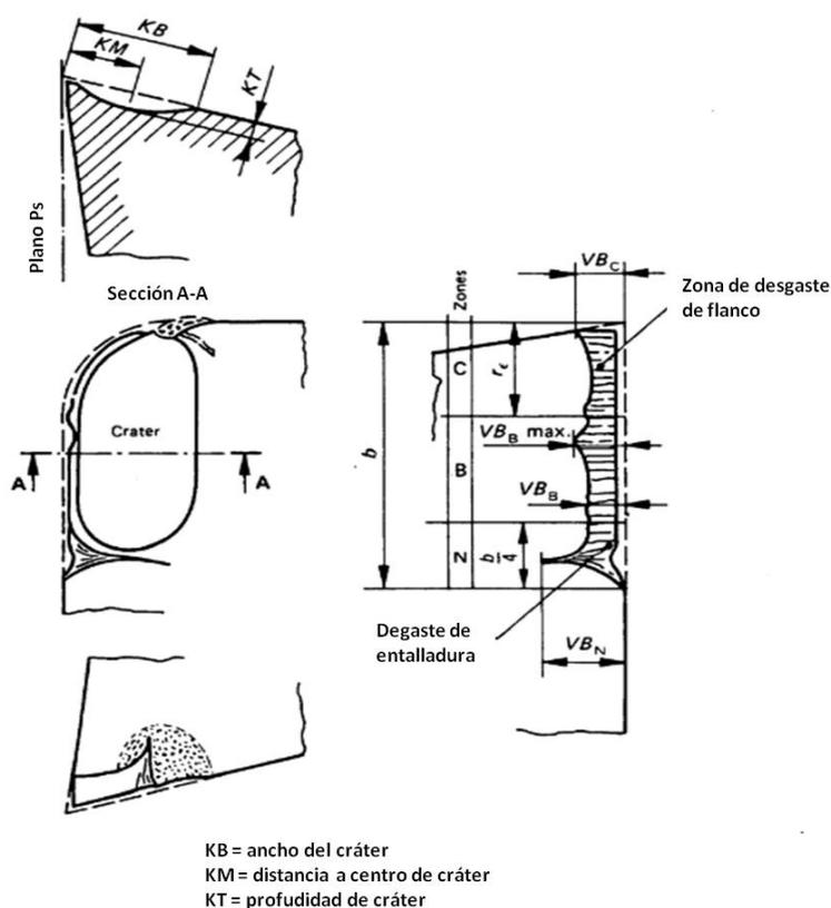
**FIGURA 2.2 ZONAS DE DESGASTE EN HERRAMIENTAS (6).**
