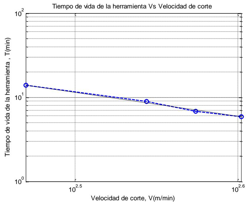
**GRÁFICA 3.4 CURVA V-T PARA  $V_{B} = 0.19\text{mm}$**
