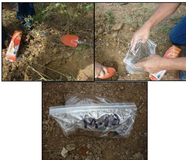
FIG. 2.5. MUESTRA PARA ANÁLISIS DE SUELO
