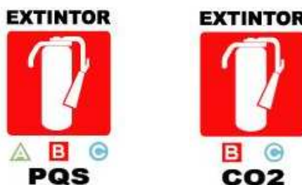
FIGURA 5.12 SEÑALIZACIÓN PARA EXTINTORES DE PQS Y CO 2 .
