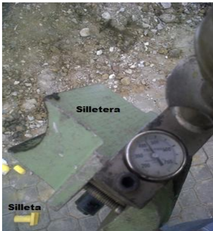
FIGURA 10 : PLANCHA CALENTADORA CON TERMÓMETRO ADAPTADO
