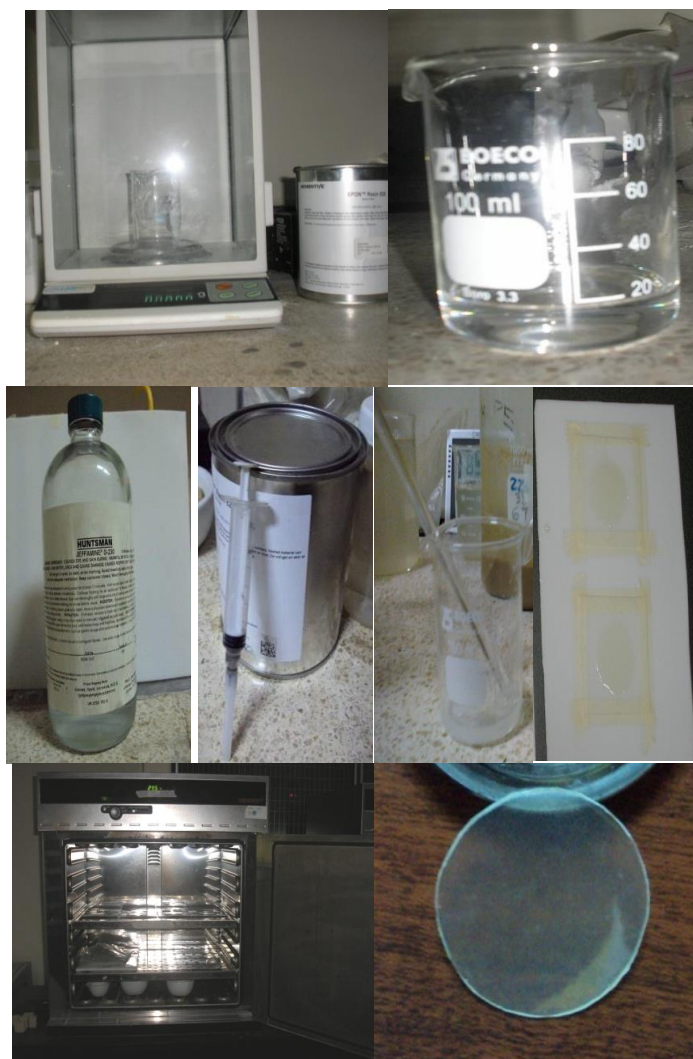
FIGURA 3.17. PREPARACION DEL COMPUESTO TRADICIONAL
