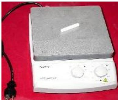
**FIGURA 3.11. AGITADOR MAGNÉTICO**
