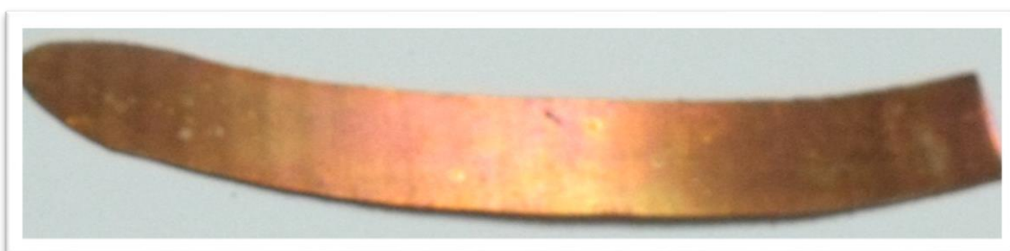
Figura 2.6. Prueba 9.3, limpieza de la lámina de cobre con seis pases de vapor.
