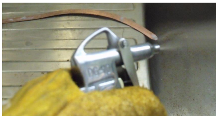
Figura 2.3. Aplicación del vapor mediante rociador.
