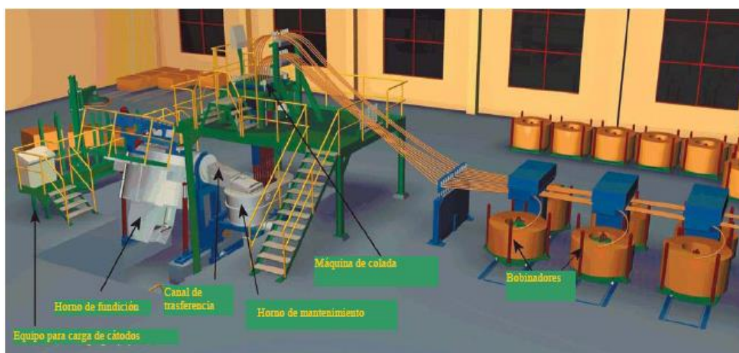
Figura 1.1. Esquema de una línea de producción continua de cobre (2)
