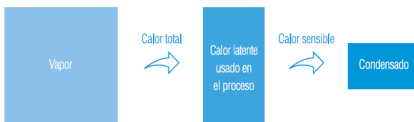
FIGURA 1.12 PÉRDIDA DE CALOR LATENTE EN EL VAPOR
