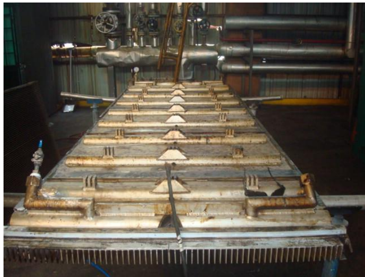
FIGURA 3.18 CONEXIONES DE ALIMENTACIÓN DE VAPOR Y DESCARGA DE CONDENSADO DE UNA BANDEJA DE SECADO
