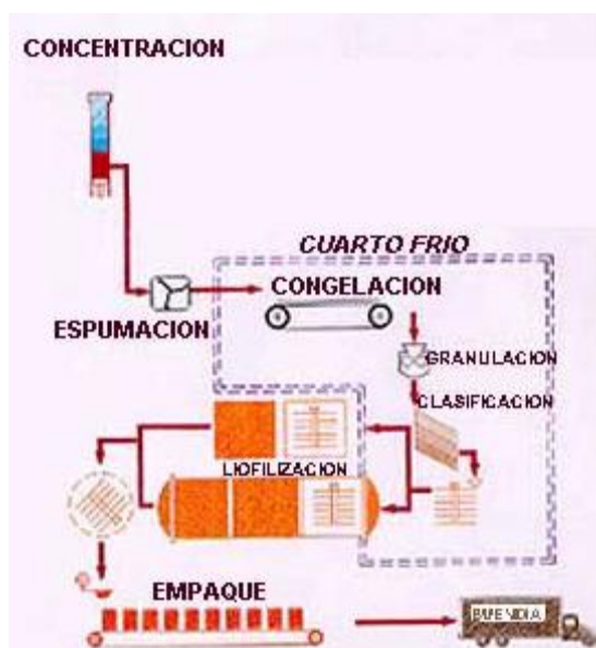
FIGURA 2.1 PROCESO DE ELABORACIÓN DE CAFÉ LIOFILIZADO
