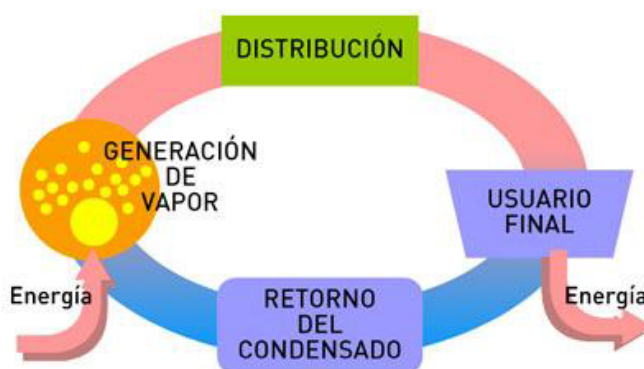
FIGURA 1.4 COMPONENTES DE UN CIRCUITO DE VAPOR INDUSTRIAL
