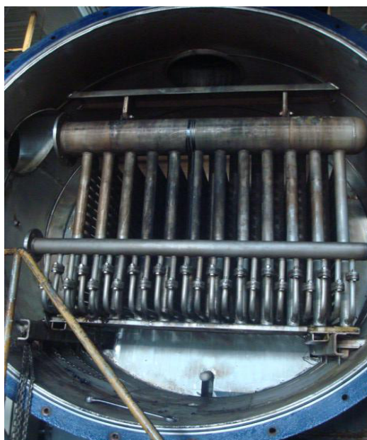
FIGURA 2.12 VISTA INTERNA DE UN CONDENSADOR
