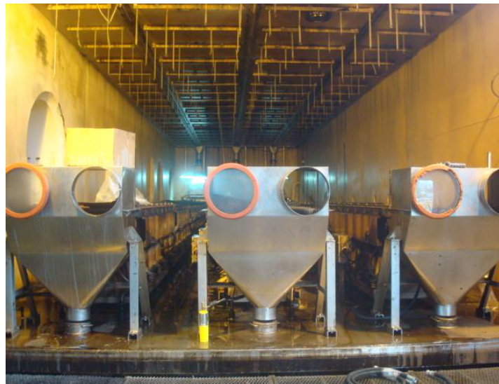
FIGURA 3.17 VISTA DE LAS TRES LÍNEAS DE SECADO DE PRODUCTO AL INTERIOR DE LA CÁMARA DE VACÍO
