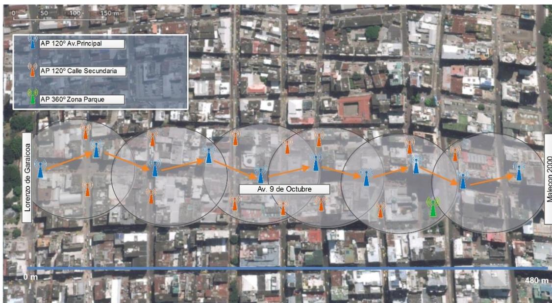
**Figura 5.13 Esquema de Diseño en toda la Av. 9 de Octubre**
