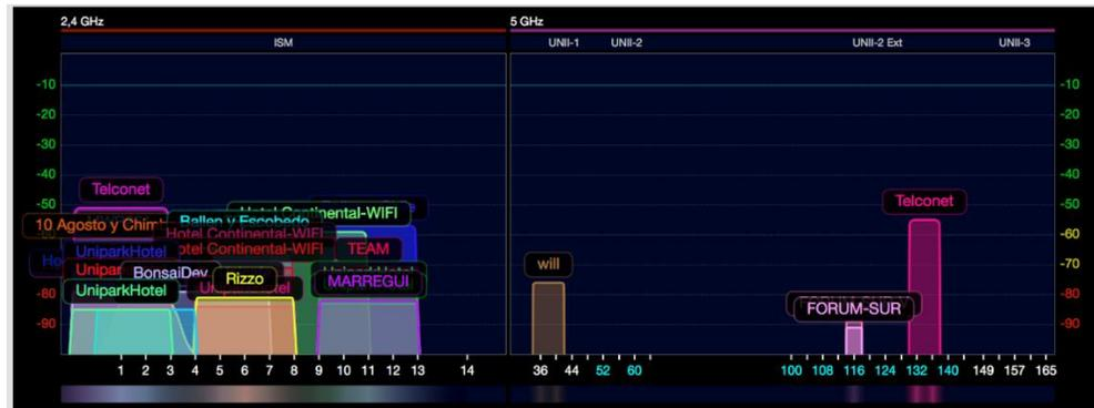
Figura 7.15 Uso de Canales de todas las redes WI-FI en el espectro electromagnético en la banda de 2.4 GHz y 5GHz (Parque Seminario)
