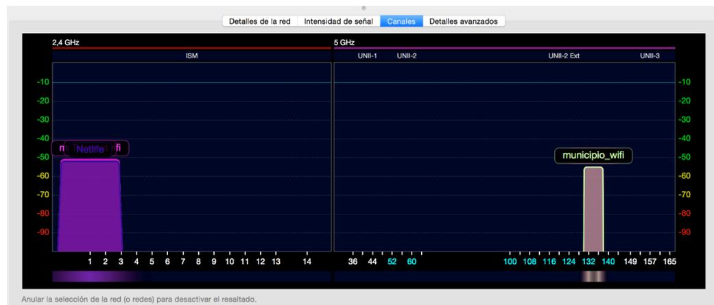
**Figura 7.7 Canales de los radios del punto de acceso en el espectro electromagnético en la banda de 2.4 GHz y 5GHz (Parque Seminario)**
