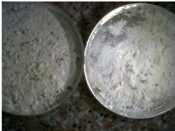
FIGURA 3.2. APELMAZAMIENTO DE LAS MUESTRAS – HUMEDAD 10%
