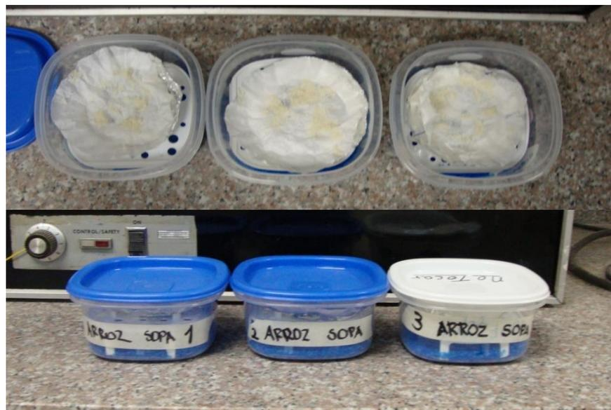
**FIGURA 2.2. SISTEMA DE SÍLICA-GEL CON MUESTRA DE MATERIA PRIMA**
