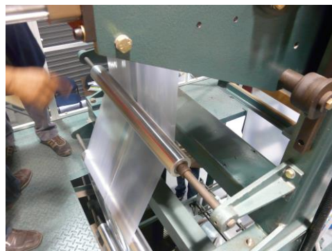
FIGURA 3.57 Sistema de Rodillos tensores o auxiliares
