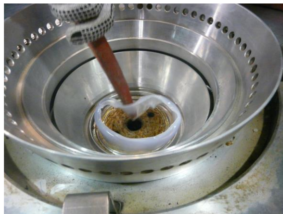
FIGURA 3.42 Forma correcta de eliminar la rebaba
