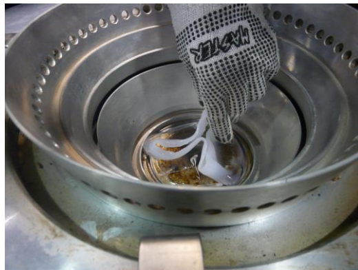
FIGURA 3.44 Eliminación total de rebaba
