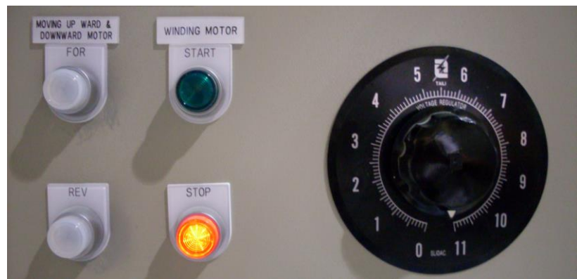
FIGURA 3.15 Botón de encendido del Motor Bobinador y Perilla para variar la velocidad; Botones para subir y bajar la bancada de los rodillos superiores
