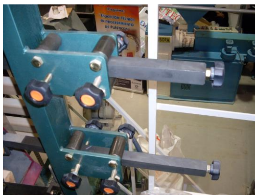
FIGURA 3.54 Tornillos de ajuste del toldo
