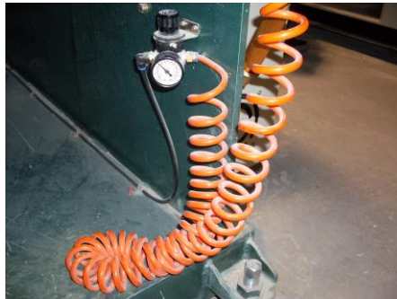
FIGURA 3.40 Aire a Presión para Bobinador
