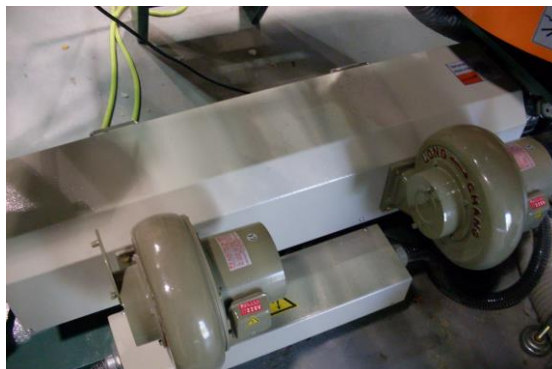
FIGURA 3.22 Refrigeración con aire
