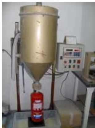
FIGURA 7.9 RECARGA DE EXTINTOR CON POLVO.
