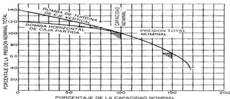
FIGURA 4.5 CURVA NORMALIZADA DE PRESIÓN – CAUDAL PARA BOMBAS DE INCENDIOS HORIZONTALES Y VERTICALES 4.2.2.2.2. Bomba a Diesel Auxiliar
