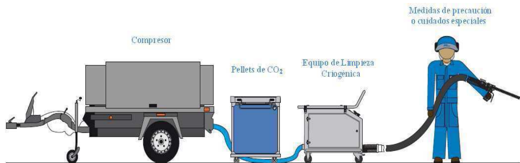
Figura 1.4 INSTALACIÓN TÍPICA DE ICEBLASTING.
