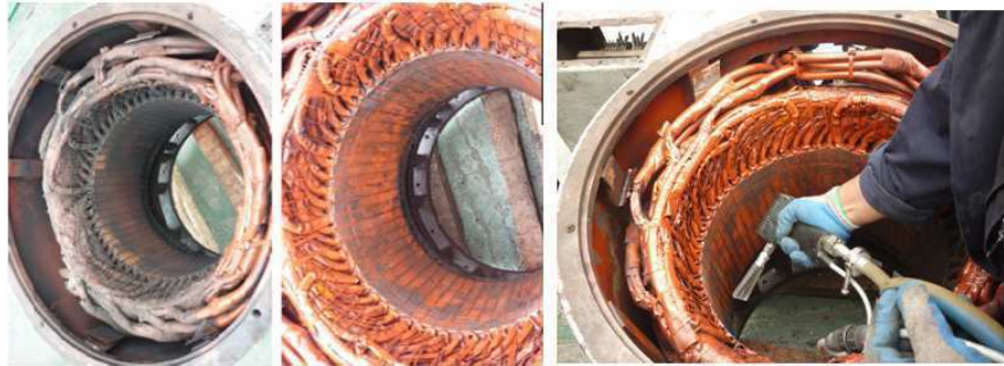
Figura 1.8 APLICACIÓN DE ICEBLASTING A UN MOTOR ELÉCTRICO.
