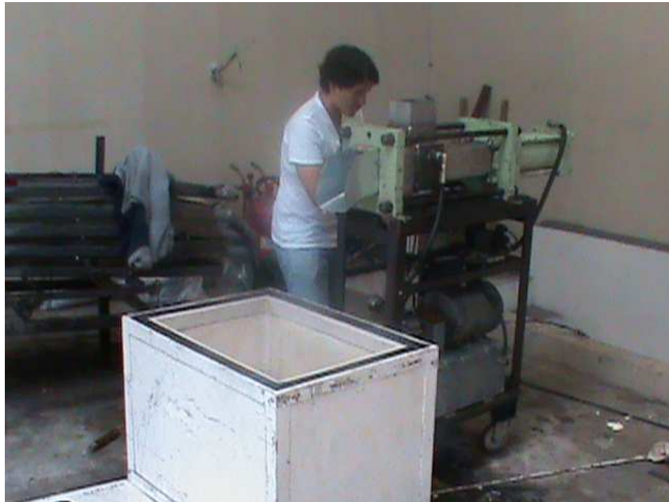
Fig. 1: Equipo extrusor de hielo seco utilizado para la toma de datos.
