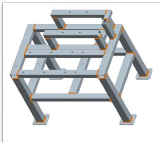
**Figura 3.40 DIAGRAMA DE ESTRUCTURA PRINCIPAL.**
