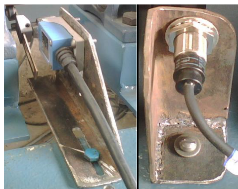
FIG. 2.21 FOTOGRAFÍA DE LOS SOPORTES TERMINADOS
