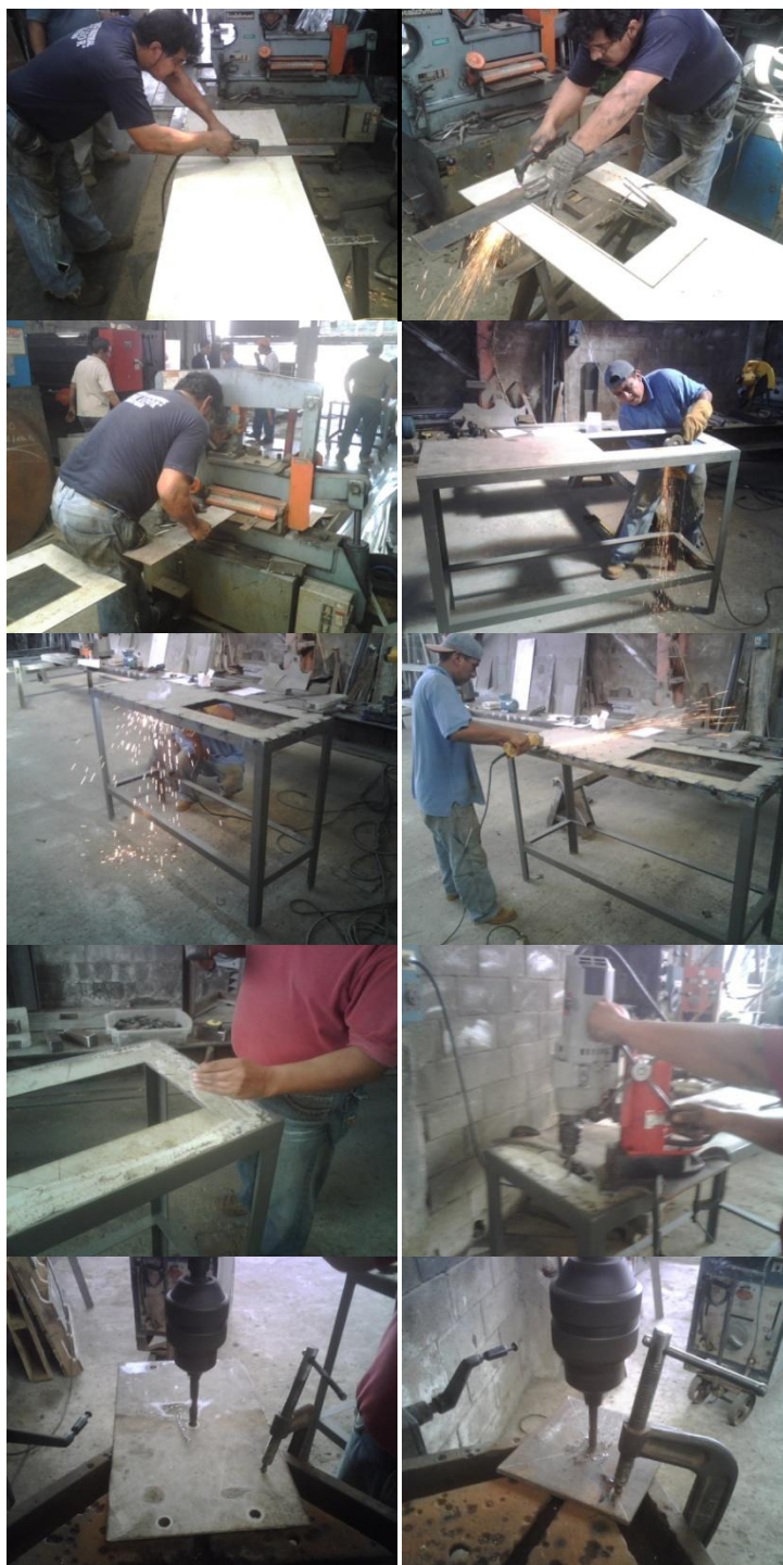
FIG. 2.11 PROCESO DE CONSTRUCCIÓN DE LASPLACAS
