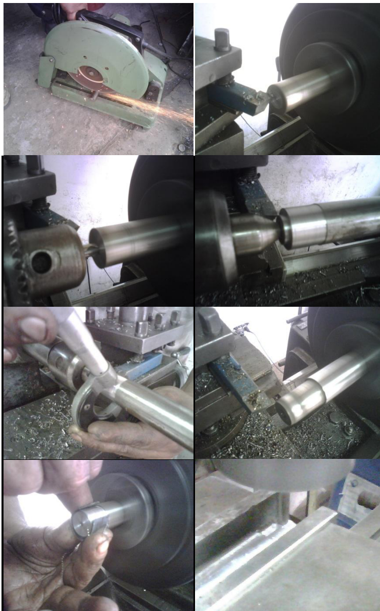
FIG. 2.3 PROCESO DE CONSTRUCCIÓN DE LOS EJES
