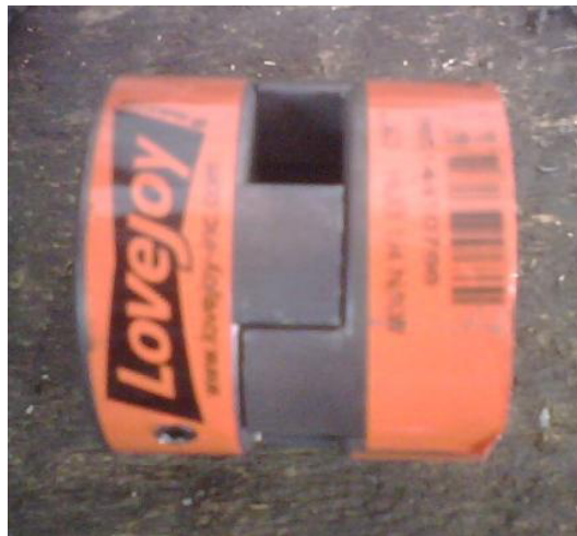
FIG. 2.4 FOTOGRAFÍA DEL ACOPLER SEMIFLEXIBLE
