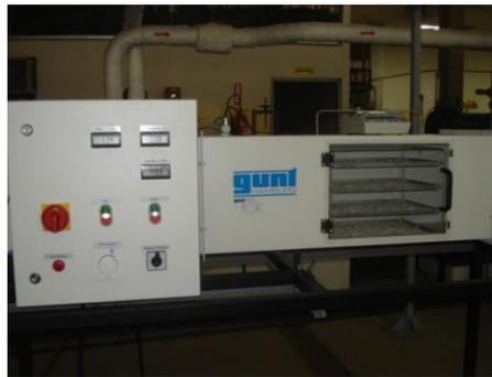
**Figura 2.3 SECADOR DE CABINA GUNT**
