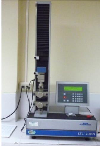
**FIGURA 3.8 MÁQUINA UNIVERSAL TMI LTL2,5KN**
