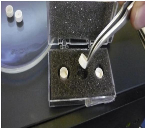
**FIGURA 3.54 CRISOLES PARA ENSAYO TGA/DSC**
