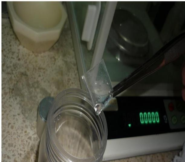
**FIGURA 3.50 USO DE LA PINZA PARA RETIRAR LA MUESTRA**
