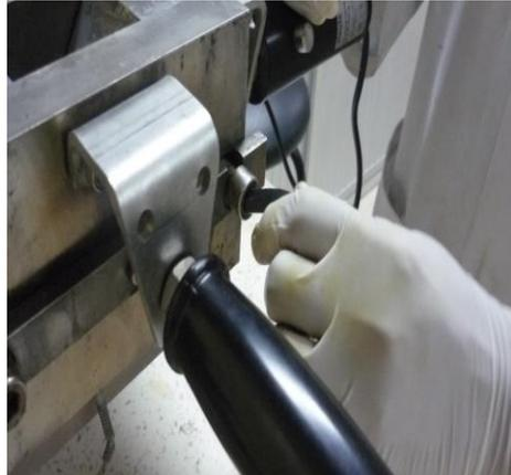
**FIGURA 3.24 RETIRAR LA PARTE FRONTAL DEL EQUIPO**
