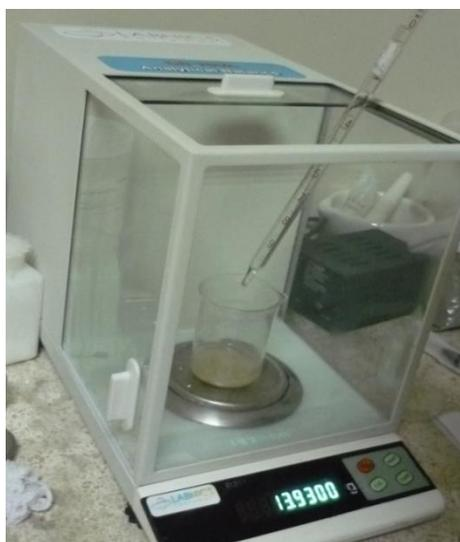
**FIGURA 3.42 AGREGAR LA AMINA UTILIZANDO LA PIPETA**
