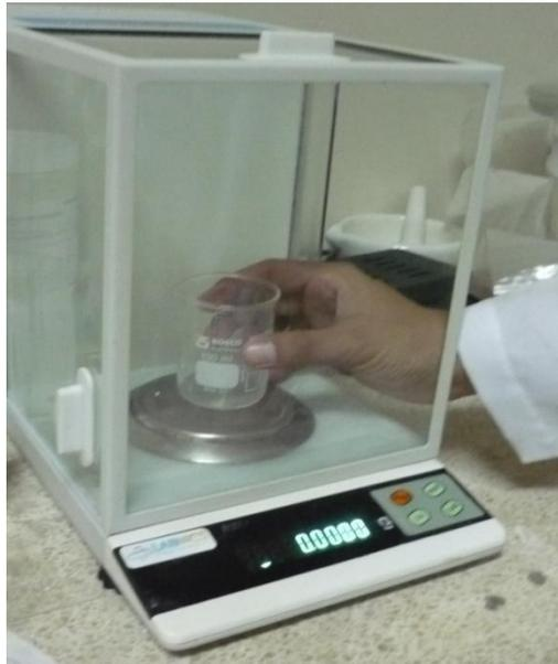
**FIGURA 3.31 PESAR EL VASO Y ENCERAR LA BALANZA**
