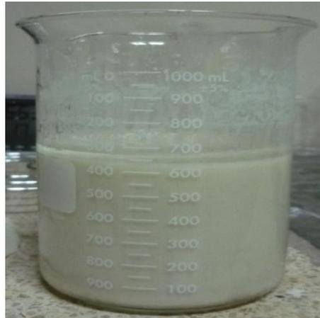
**FIGURA 3.28 ARCILLA EN PROCESO DE LAVADO -
