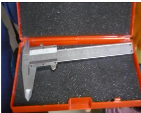
**FIGURA 3.16 CALIBRADOR VERNIER**
