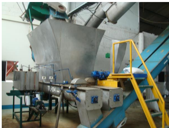
FIGURA 2.1 SISTEMA DE APLICACIÓN DEL AGENTE BACTERICIDA
