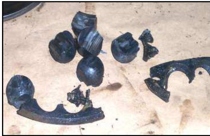
Figura 4.8 Elementos rodantes y canastilla del rodamiento 7222
