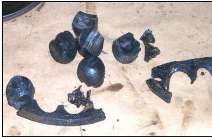
**Figura 4.8 Elementos rodantes y canastilla del rodamiento 7222**
