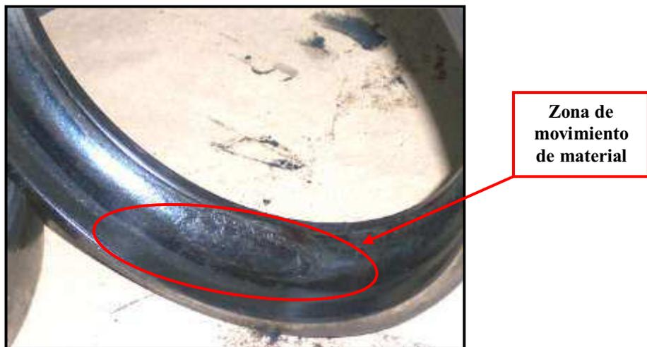
**Figura 4.5 Pista exterior del rodamiento lado del acople.**
