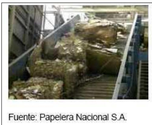
**Figura 1.7 Transportador de Recursos Fibrosos**
