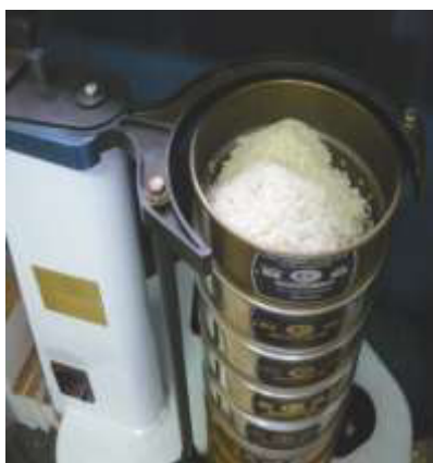
FIGURA 2.9 USO DE TAMICES EN PRUEBA GRANULOMÉTRICA
