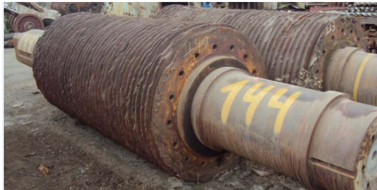
Figura 1.7 VISTA FRONTAL DE MAZAS DESGASTADAS
