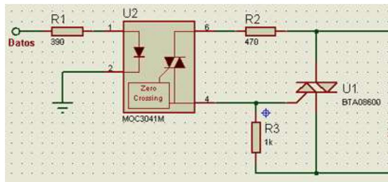
**Figura 2.5 – Diagrama circuito control pistola de calor**
