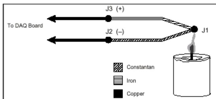
**Figura 2.3 - Termopar tipo J**
