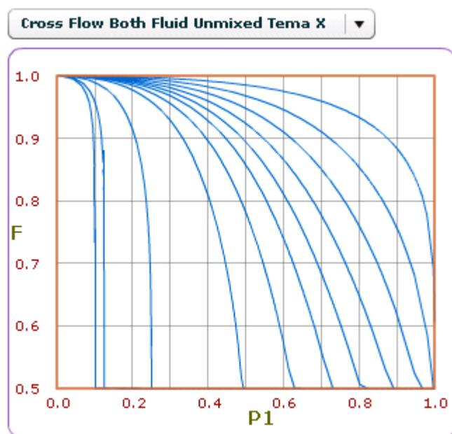
**Figura 4.4 – Factor de corrección para un intercambiador
