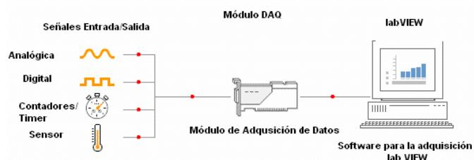
**Figura 2.1 – Esquema descriptivo de la adquisición de datos**
