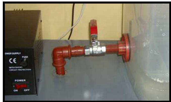
**Figura 1.5 – Conexión tanque-tanque**
