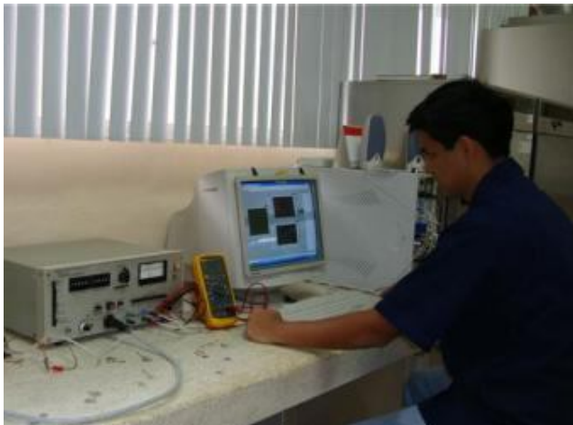
Figura 1.42 Ejecución de Ensayos Cinéticos de Corrosión
