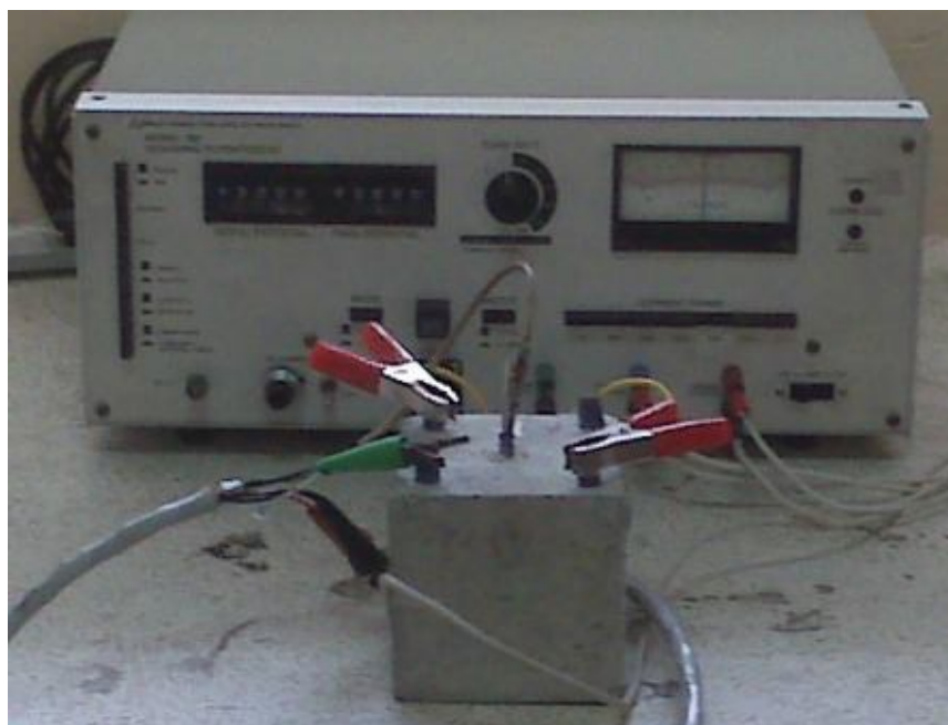
Figura 2.1 Conexión de Potenciogalvanostato y Probeta de Hormigón
