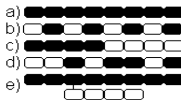
FIGURA (2.5) A) HOMOPOLÍMERO B) COPOLÍMERO ALTERNANTE C) COPOLÍMERO EN BLOQUE D) COPOLÍMERO ALEATORIO E) COPOLÍMERO DE INJERTO. [3].
