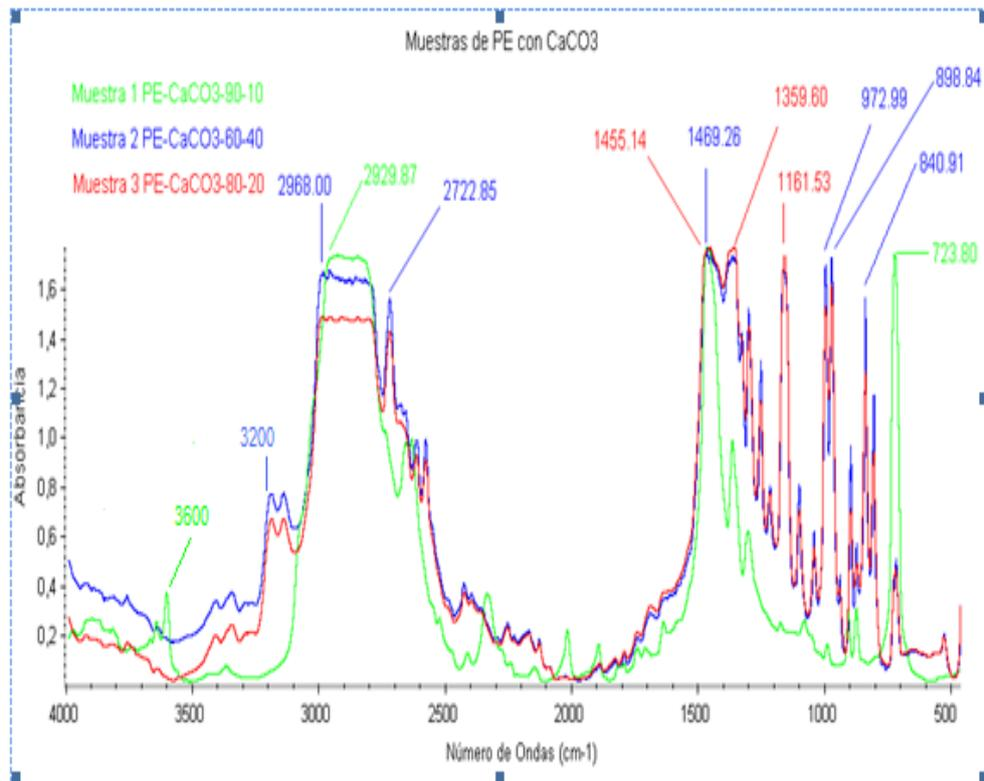
FIGURA (4.1) GRÁFICO DE MUESTRAS DE POLIETILENO CON CaCO<sub>3</sub>.
