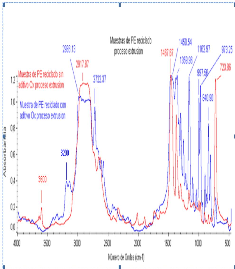
**FIGURA (4.4) GRÁFICO DE MUESTRAS DE POLIETILENO RECICLADO CON ADITIVO OX Y SIN ADITIVO OX PROCESO EXTRUSIÓN.**
