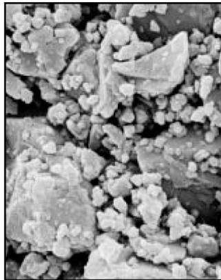
**FIGURA (2.23) MICROESTRUCTURA DEL CARBONATO DE CALCIO.**
