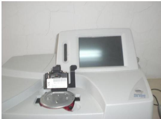
**FIGURA (3.8) ESPECTÓMETRO DE FTIR.**
