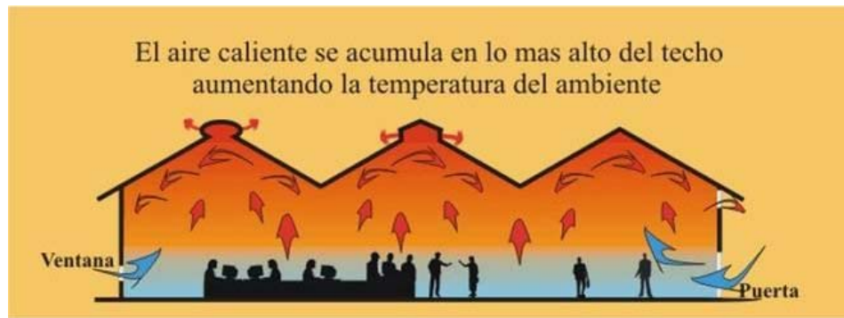
FIGURA 4.4 EDIFICIO SIN SISTEMA DE VENTILACIÓN
