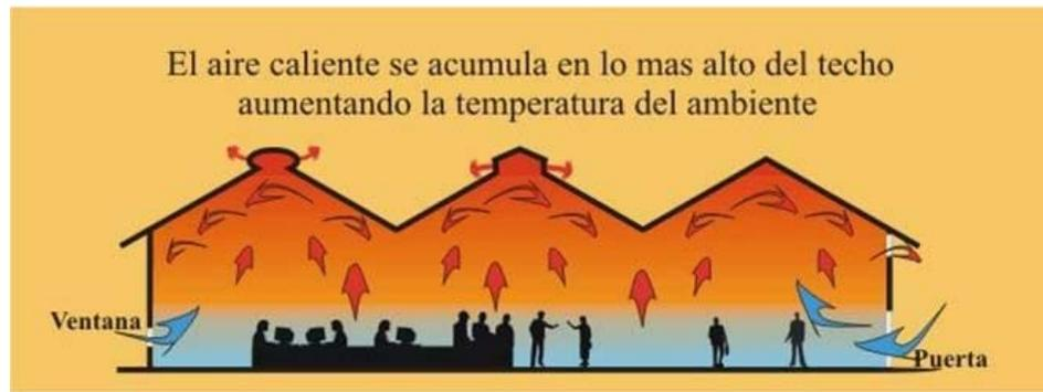
**FIGURA 4.4 EDIFICIO SIN SISTEMA DE VENTILACIÓN**
