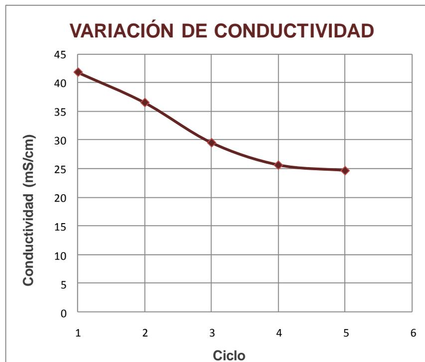
De igual forma, se analizó la resistividad de la salmuera. La cual, contrario a la conductividad eléctrica, incrementó después de cada ciclo, aunque de manera casi imperceptible. Esto nos confirma que existe una pequeña disminución en la capacidad del paso de energía eléctrica, al haber un incremento en la resistividad. En la figura 2.5 se muestran los resultados de los análisis.
