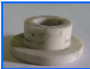
FIGURA 3.21: BOCÍN CON MATERIAL DE TEFLÓN
