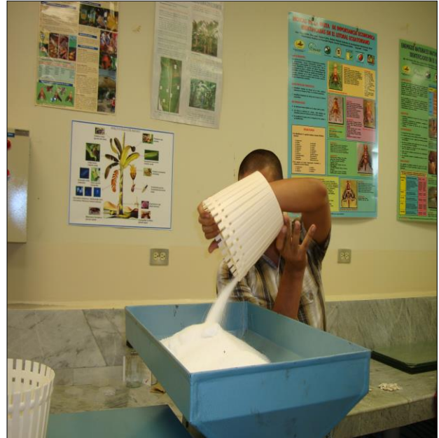
Urea en grano colocada en la tolva
