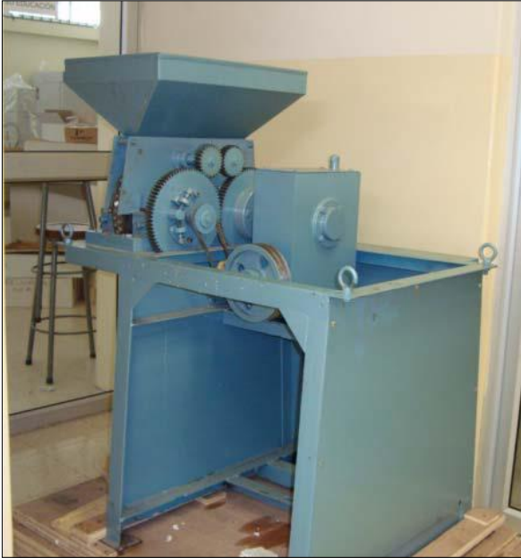
Máquina Briqueteadora a motor
