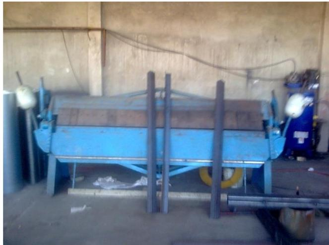
Dobladora 2.50mts largo útil de dobles, 15 dados con terminales en acero crónica T-100, para doblar plancha hasta 2 mm en todo su largo útil 1/8 en tramos de 1.20metros, sistema excéntrico.
