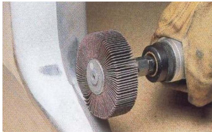
Figura 1.29 PULIDO MECÁNICO “IN SITU” CON ABRASIVOS Y FELPAS CON PASTA DIAMANTADA.
