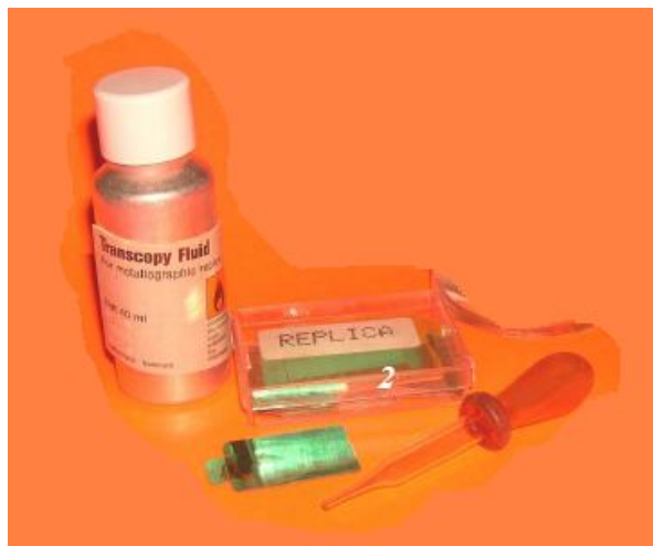
Figura 1.5 EQUIPO PARA REPLICAS FABRICADO POR STRUERS, INCLUYE EL SOLVENTE Y EL KIT CON 50 REPLICAS
