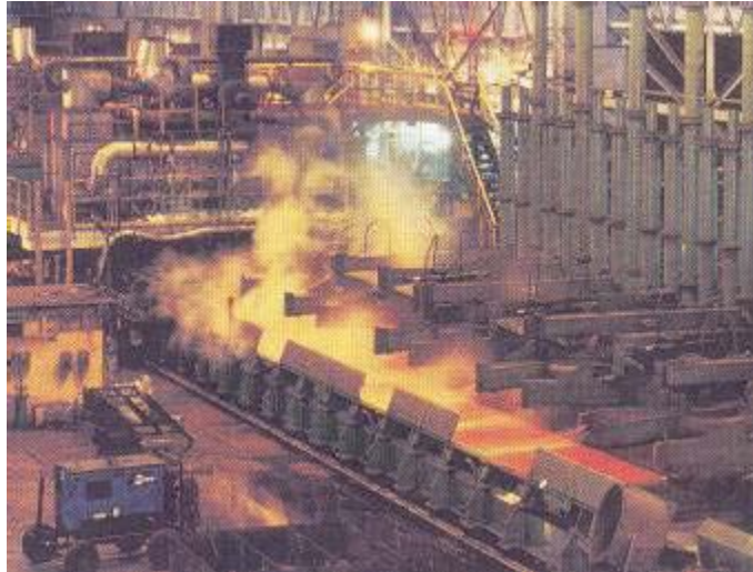
Figura 1.2 PROCESO DE LAMINACIÓN EN CALIENTE
