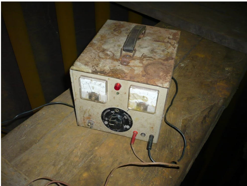
Figura 2.6 RECTIFICADOR DE CORRIENTE DC - AC
