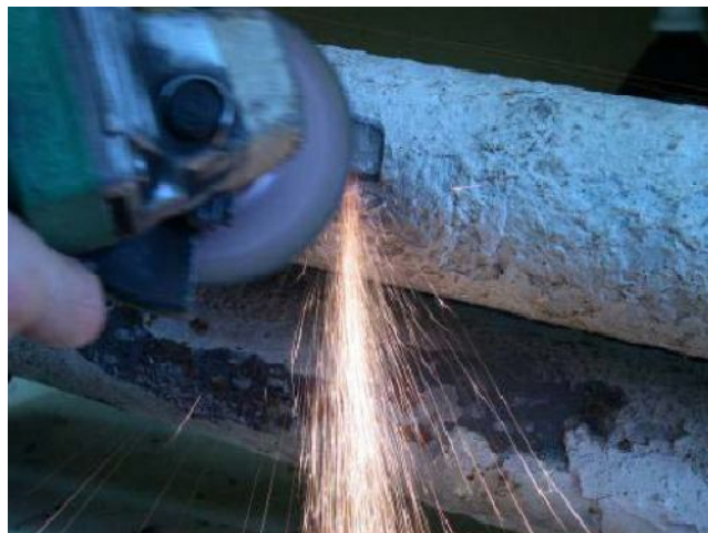
Figura 1.27 DESBASTE GRUESO CON EL USO DE UNA AMOLADORA PORTÁTIL
