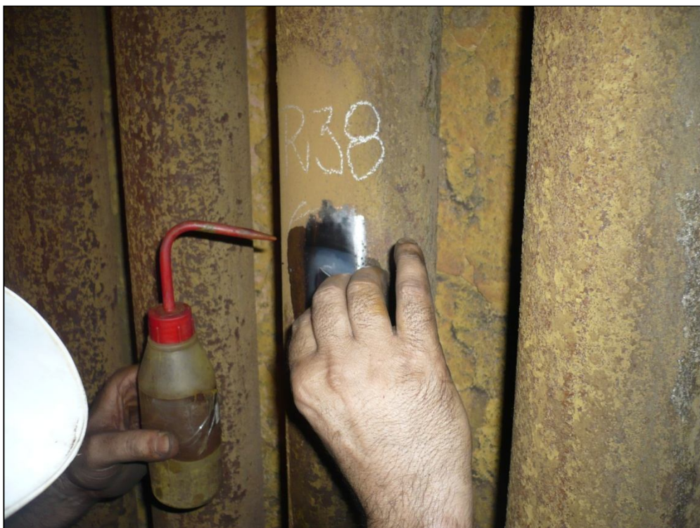
Figura 2.17. SE COLOCA UNA CAPA DE DISOLVENTE (ACETONA) A LA SUPERFICIE PARA LUEGO ADHERIR LA HOJA DE ACETATO POR TENSIÓN SUPERFICIAL
