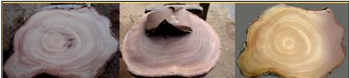
Secciones terminadas: Lijado y Pulido
