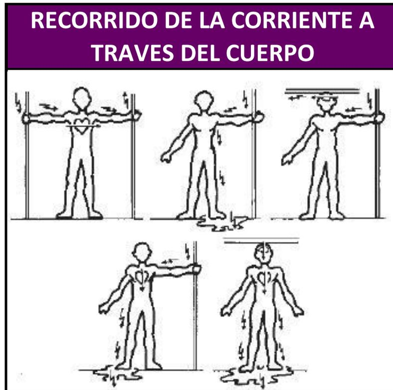
**FIG 3.3 RECORRIDO DE LA CORRIENTE A TRAVÉS DEL CUERPO**
