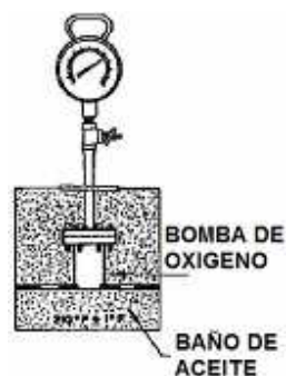
Figura 1.35 Equipo para probar la Estabilidad a la Oxidación.
