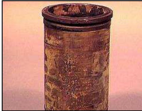
Figura 1.22 Desgaste por Cavitación.
