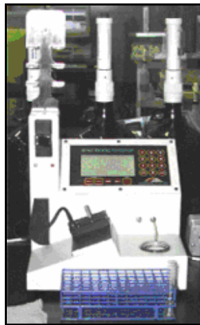
Figura 1.29 Equipo ISO 4406/1999 para Ferrografía Directa.
