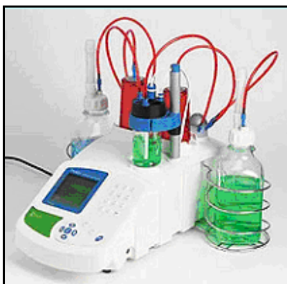
Figura 1.33 Potenciómetro para determinar el TBN.
