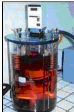
Figura 1.34 Equipo para Probar Formación de Espuma en el Aceite.
