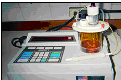
Figura 1.36 Equipo de Prueba con Reactivo Karl Fischer.
