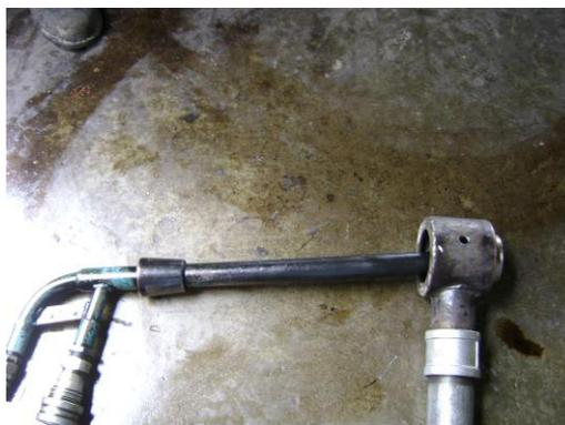
**Fig. 3.16** Ensamble Anillo Quemador
