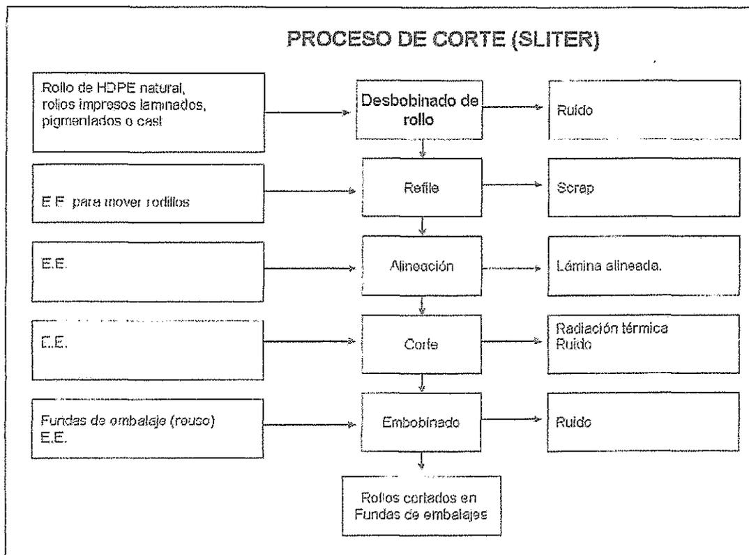
**Gráfico 9.6 Diagrama de flujo # 6 del proceso de Corte.**
