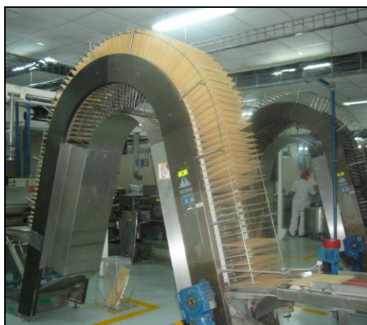
FIG. 2.3 ARCO DE ENFRIAMIENTO
