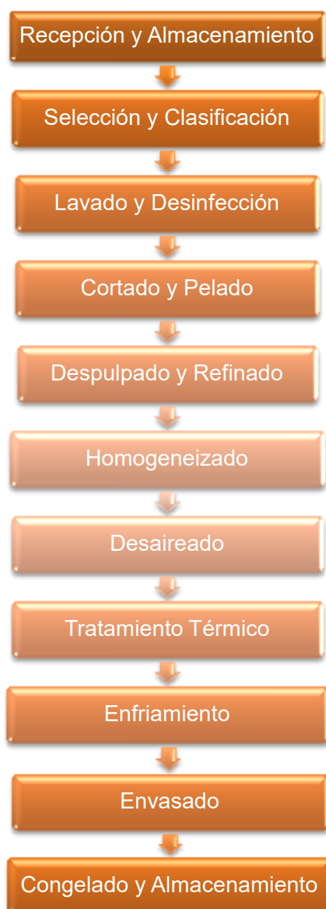
FIGURA 1.3 DIAGRAMA DE FLUJO PARA LA ELABORACIÓN DE PULPA CONGELADA
