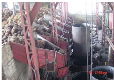
FIGURA 4.3 AUTOCLAVES VERTICALES CON CAPACIDAD DE 2632 Kg.
